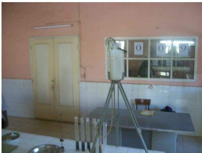
Figure 2: Photo de cylindre qui contient les éléments granulométriques et bidon réservoir de la solution de Hexamètophosphate de sodium.
